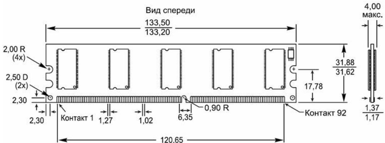
Рисунок 3.4 184-х контактный модуль памяти DDR SDRAM
