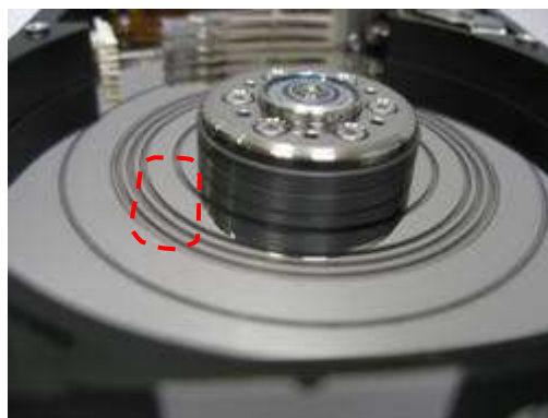
Рисунок 8 - Поврежденная поверхность магнитного диска
